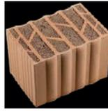
Es wird getestet, die Steine alternativ mit Schafwolle auszufüllen. Das Mauerwerk vereint sämtliche Trag-, Dämm- und Schutzfunktionen auf höchstem Niveau. Mit dem Capo ist es möglich, Arbeitsgänge einzusparen, wie das Anbringen der Aussendämmung oder das Aufmauern der zweiten Schale. Zudem kann sogleich nach dem Erstellen des Mauerwerkes mit dem Innenausbau gestartet werden. Der Capo wird mit dem speziell dafür entwickelten Mörtelschlitten oder mit Mörtelpads im Dünnbettverfahren vermauert.
