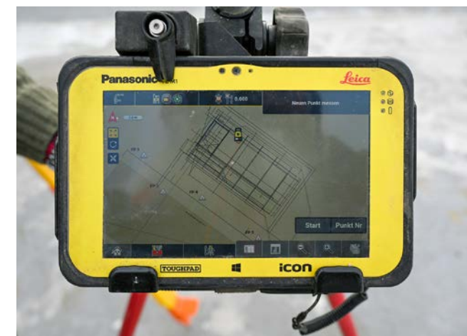
▲ Ansicht der Fixpunkte, an welchem sich das Gerät orientiert.
