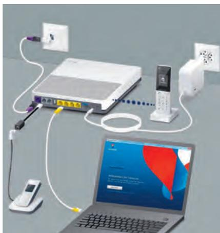
Übersicht Router mit Anschlussmöglichkeiten.
